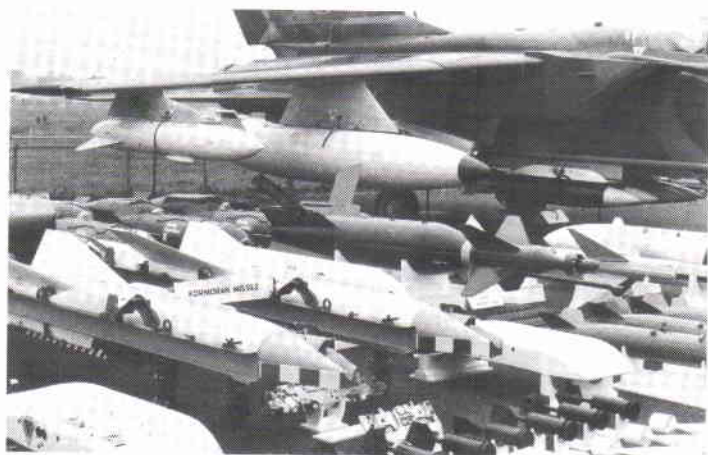
Laserstyrda bomber, attackrobotar, raketter, multipelvapen med substridsdelar, fallskärmsbromsade och slutfasaccelererade vapen förut slagning av bansystem, utgör exempel på beväpningsalternativ för den trinationella attackversionen av Tornado.
